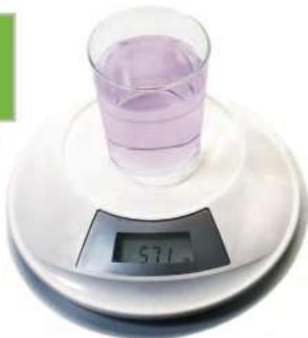
Si la masa del recipiente con el líquido es de 571 g y la masa del recipiente vacío tiene una masa de 233 g, la masa del líquido es 338 g.
